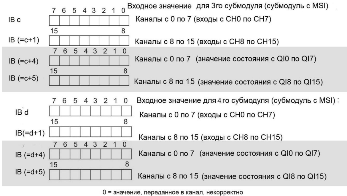
Рисунок 4-4 Пространство адресов при конфигурации модуля DI 16x24V DC SRC BA MSI
